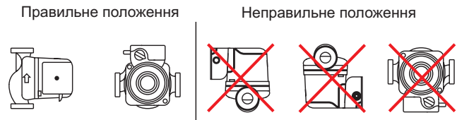
Мал. 3. Монтаж насоса.
