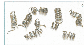
Свободно намотанная (витая) стружка - идеальные условия резания
